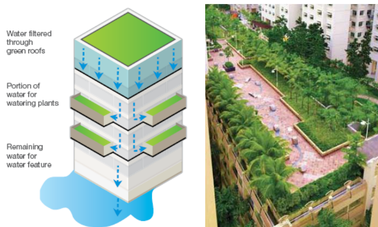
Figuras 26 e 27: Esquema e aplicação de teto verde. Fonte: CINGAPURA, 2011.
