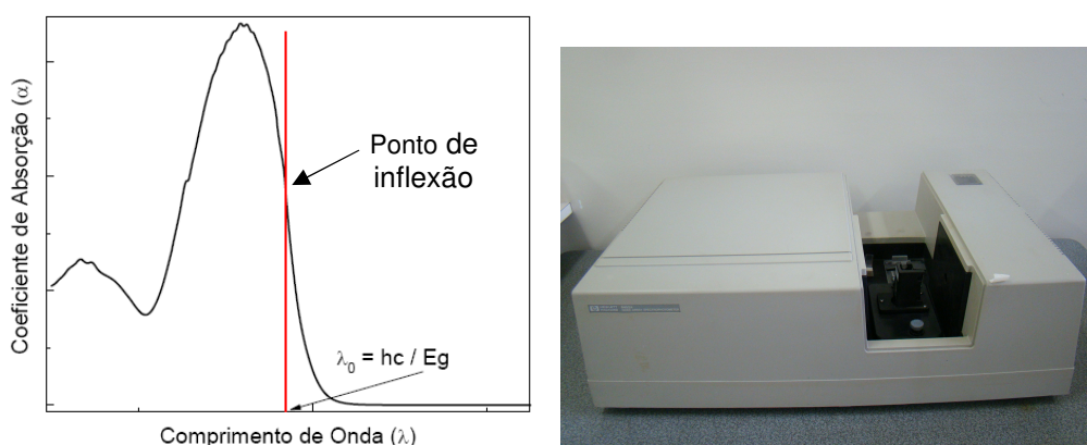
Figura 3-11 – Exemplo de um espectro de absorção com a indicação de comprimento de onda \lambda_0 do gap.
