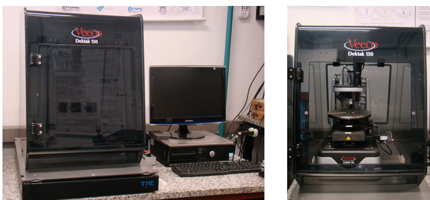
Figura 3-10 – Perfilômetro Veeco Dektak 150 utilizado para as medidas de espessura.
