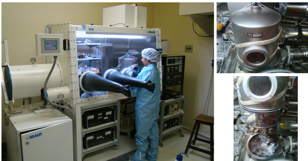
Figura 3-7 – Configuração atual do sistema de deposição: câmara UNIVEX 300 acoplada à glove-box MBraun modelo 200B.
