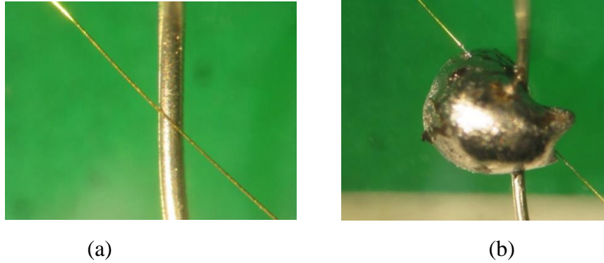
Figura 23: Fio de tungstênio e fio mais espesso (a) sem solda e (b) com a solda.
