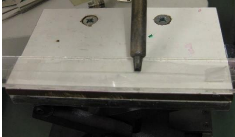
Figura 21: Ferro de solda posicionado próximo à fibra óptica para derreter o metal visando a colocação de um fio de tungstênio revestido de Au para contato elétrico.
