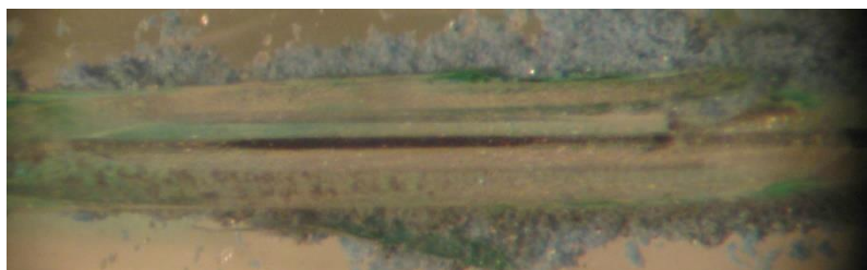
Figura 20: Fibra F051007-1C com o eletrodo exposto (parte escura, no centro da imagem).
