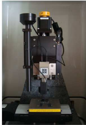
Figura 3.3 - Foto do nanoindentador instalado no Laboratório Van de Graaf na PUC-Rio.
