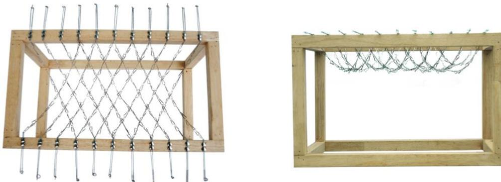
Fig. 69: Modelos de catenária usados para encontrar a curvatura da estrutura (Imagens extraídas de ROCKWOOD, 2013)
