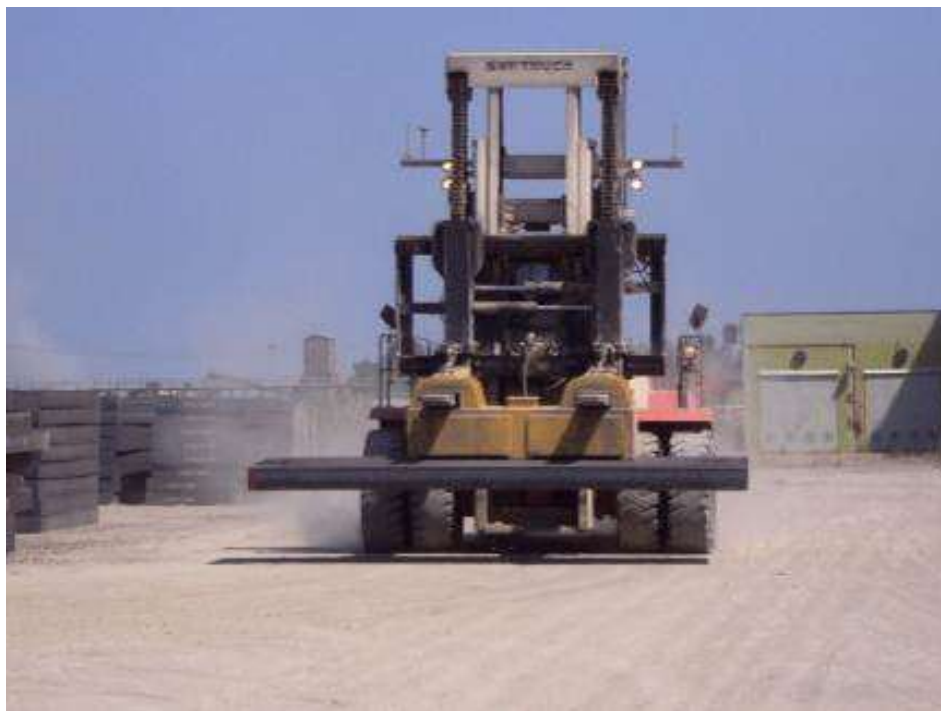
Figura 13: Ilustração da Empilhadeira de Eletroímã
