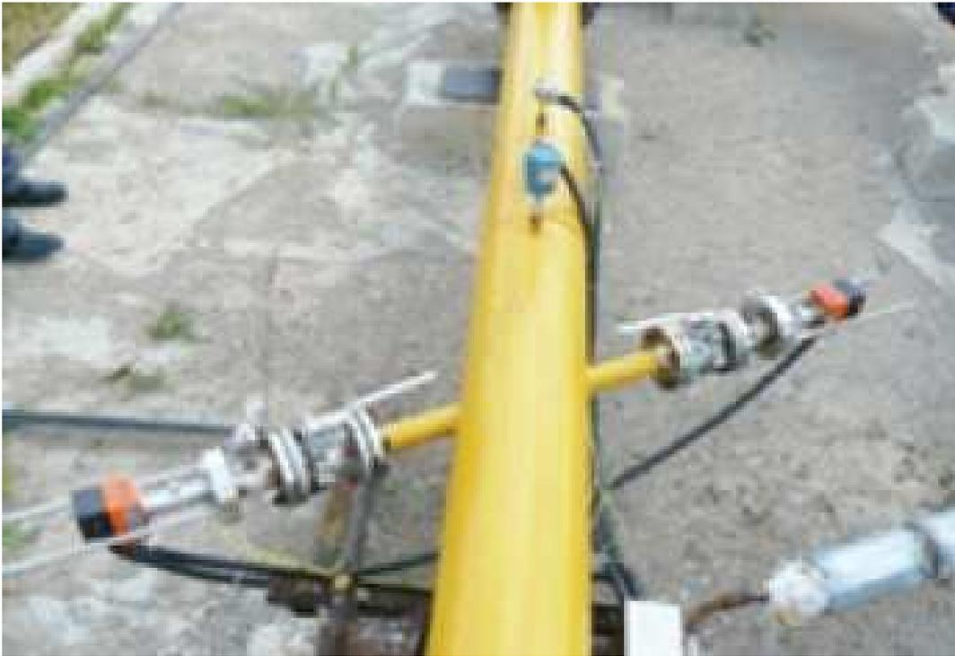
Figura 6 - Medidor típico, transdutores em plano longitudinal diametral (NPP, 2007)
