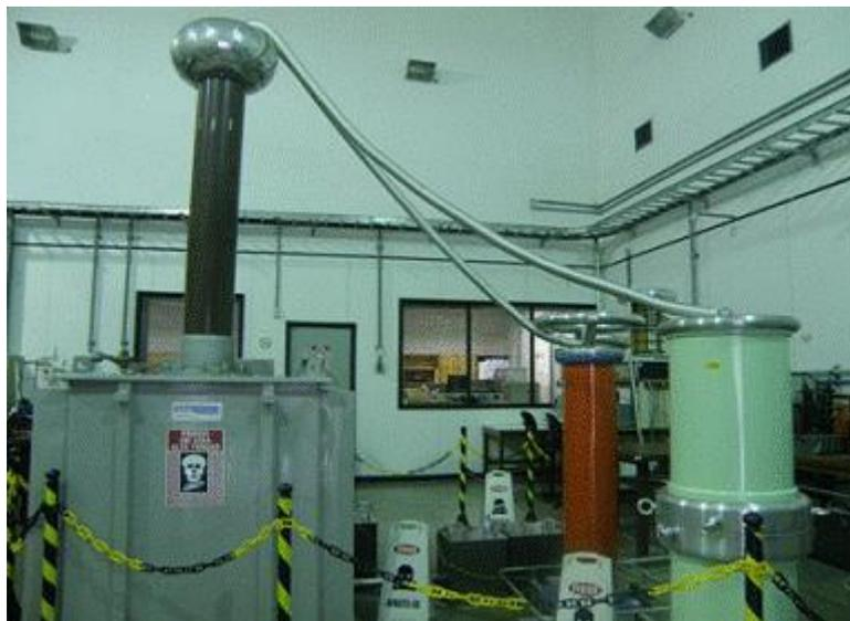
**Figura 38: Sistema de medição de referência de alta tensão alternada e corrente alternada no Lamat**
