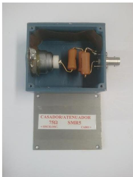
**Figura 47: Atenuador/casador para cabos de  $75 \Omega$**
