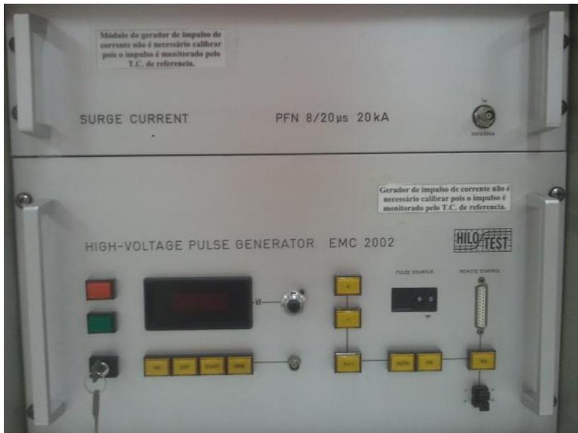
**Figura 433: Gerador de impulsos EMC 2002**
