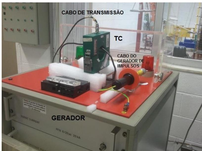
**Figura 444: Transdutor do sistema de medição de impulsos de corrente**
