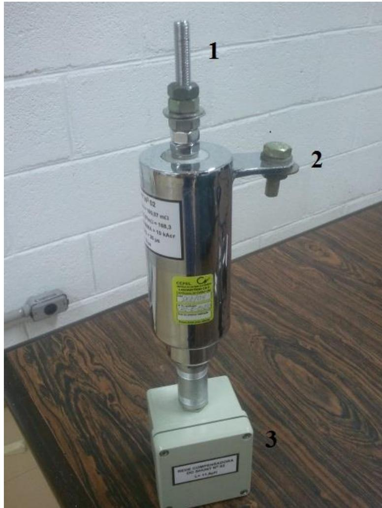
Figura 6: *Shunt*: (1) Porta de entrada da corrente, (2) Conexão *Shunt-Terra* e (3) Porta de saída do sinal de tensão
