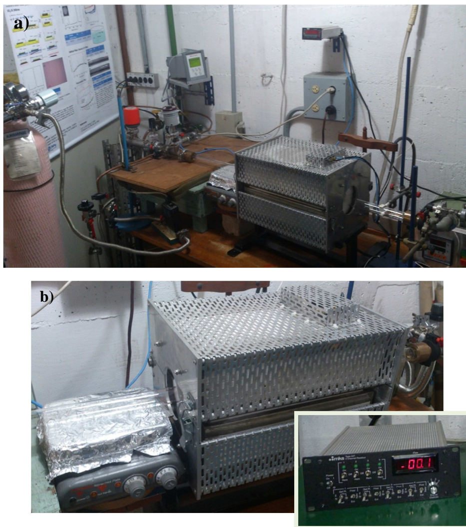
Figura 4.2 Sistema de crescimento por HVCVD instalado no Laboratório Van de Graaff. b) Detalhe do forno e a placa quente usados. No insert , controlador de fluxo de gás usado.
