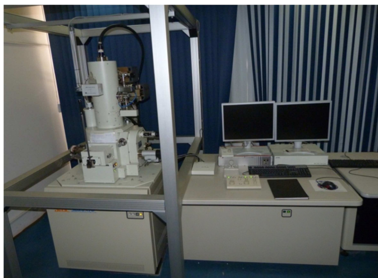
Figura 3.9 Fotografia do microscópio modelo JSM-6701F instalado no Laboratório de Revestimentos Protetores e Materiais Nanoestruturados.
