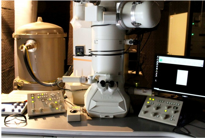
Figura 3.10 Fotografia do microscópio JEM 2100F usado nas medidas por MET. Laboratório de Nanociência e Nanotecnologia (LABNANO), CBPF.
