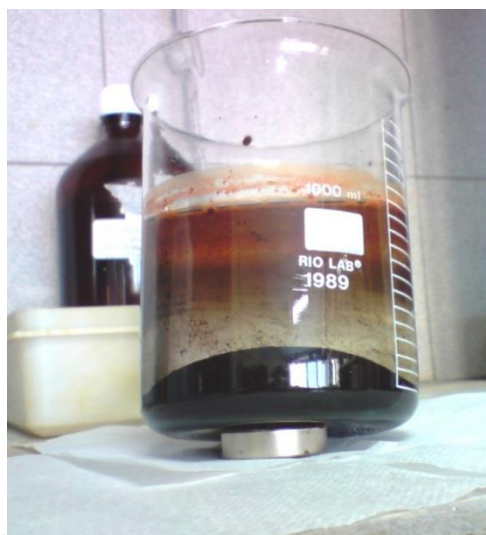
Figura 3.5. Fabricação das nanopartículas mediante co-precipitação. Nota-se o ímã embaixo do becker, o líquido preto correspondem às nanopartículas de óxido de ferro.
