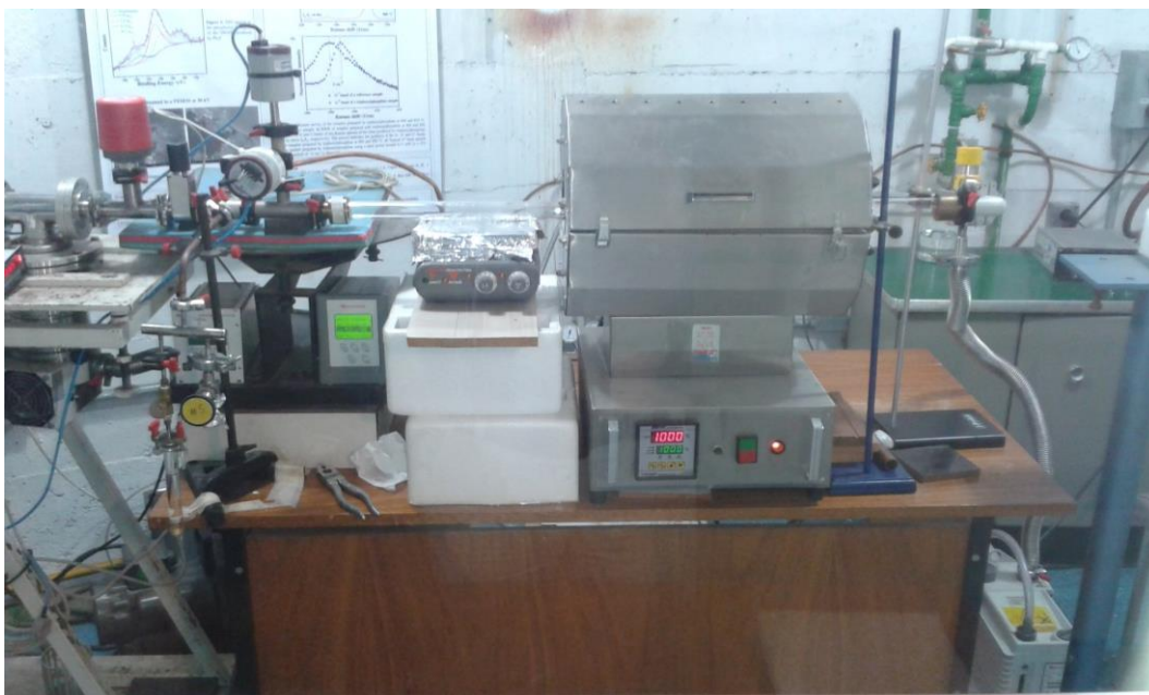
Figura 3.1: Sistema de crescimento do tipo HVCVD, utilizado para a síntese de nossas amostras.
