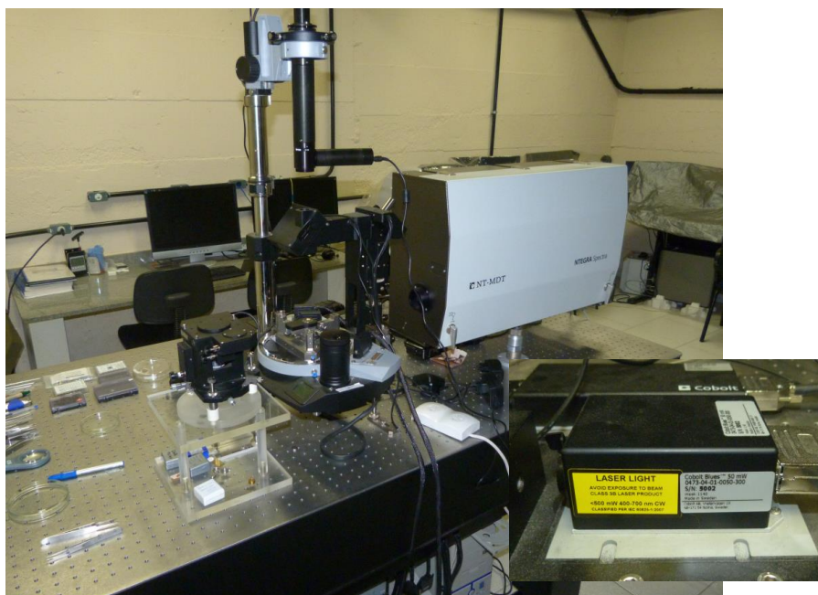
Figura 4.6: Espectrômetro Raman confocal (configuração Upright ) da NT-MDT, tipo NTEGRA SPECTRA. O laser é mostrado na figura inserta.
