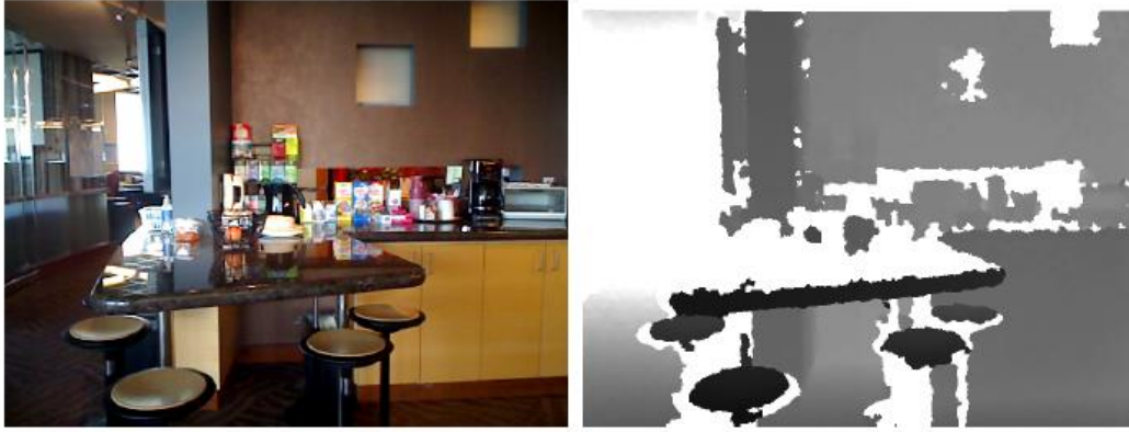
Figura 5 – Imagem RGB à esquerda e informação de profundidade captada por uma câmera RGB-D à direita. Fonte: Henry et al. (2014)
