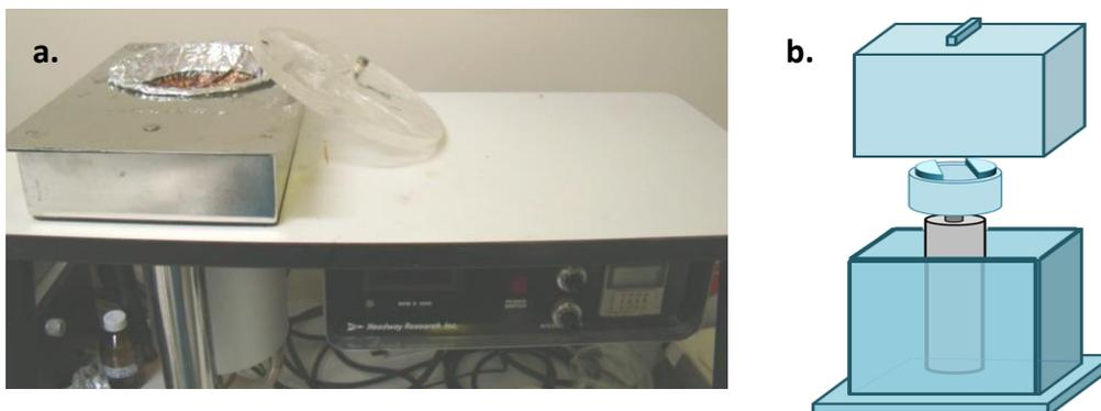
**Figura 3.7 - a.** Equipamento de deposição por spin coating da empresa Headway Research Inc. **b.** Para materiais orgânicos sensíveis a presença de umidade e de oxigênio, um pequeno sistema “*home-made*” de spin coating foi desenvolvido para que possa ser usado dentro da *glovebox*.
