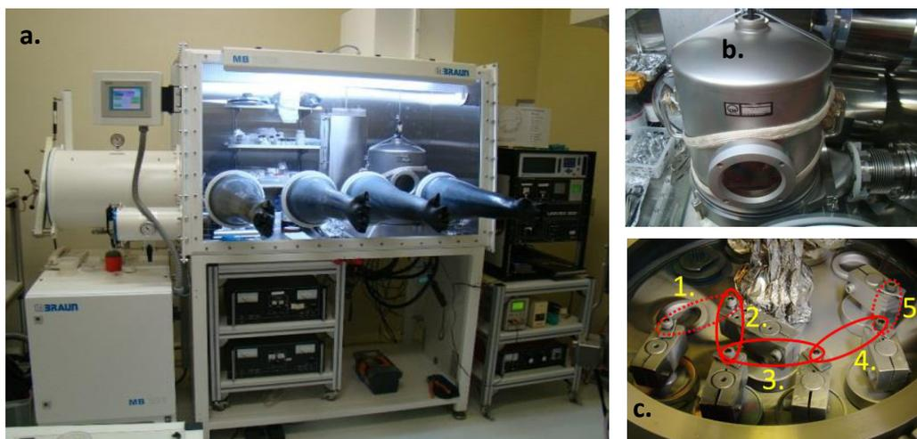
**Figura 3.5** - a. Fotografia do sistema de deposição Leybold 300 acoplada a uma *glovebox* Mbraum, b. a câmara de deposição, c. as 5 disposições possíveis para a colocação de cadinhos na câmara de deposição.
