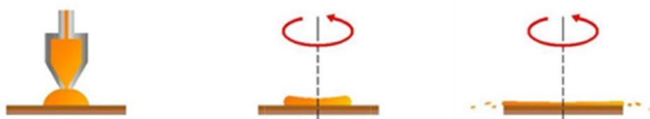
Figura 36 - Esquema de deposição por *spin-coating*.
