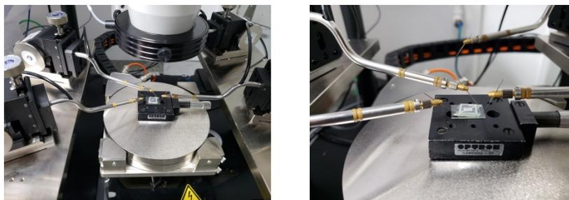
Figura 44 - Acima, o novo *set-up* experimental para a caracterização de OLETs nas dependências do LOEM. O sistema é composto por uma *probe station* EPS150X ligada a um analisador de semicondutores Keysight B2912A. Embaixo, detalhe das pontas de prova sendo usadas em uma medida elétrica.
