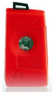
Figura 5.5: O Texas Instruments CC2541 Sensor Tag é primariamente um sensor multiuso, porém também é usável como um Beacon BLE
