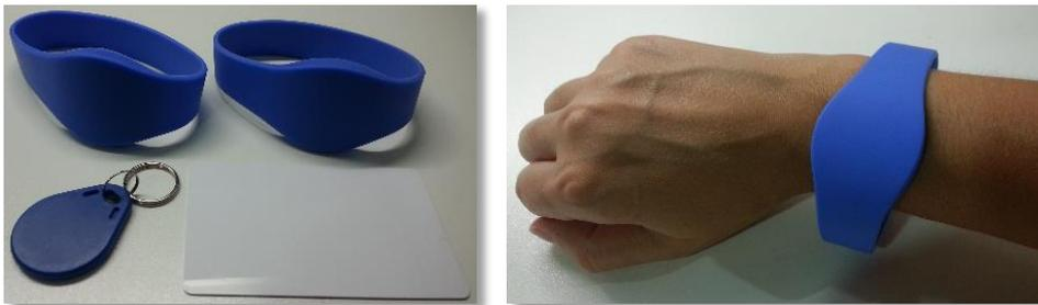
Figura 33 – Acessórios com tags RFID utilizados na identificação de pacientes.
