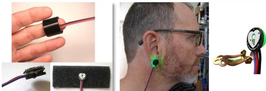
Figura 15 – O Pulse Sensor pode ser utilizado na ponta do dedo (à esquerda) ou na orelha (à direita).
