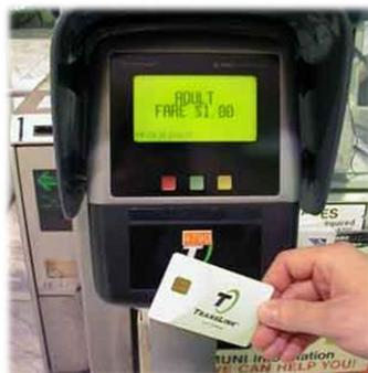
Figura 10 - Leitor RFID e cartão inteligente sem contato<sup>15</sup>.
