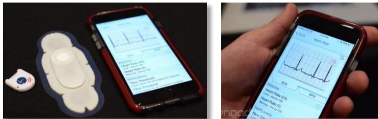
Figura 3 - HealthPatch MD – Dispositivo de monitoramento<sup>6</sup>.
