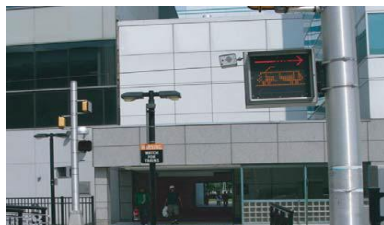
Figura 4-6 Sinais ativos de aviso de aproximação do VLT. Fonte: Cleghorn et. al., (2009); Pecheux e Saporta (2009).
