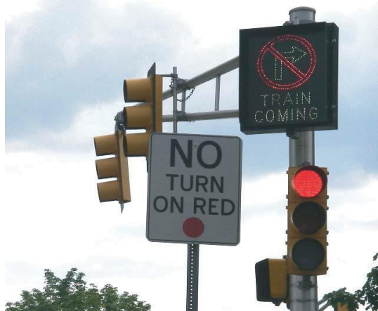
Figura 4-7 Sinais ativos de proibição de conversão. Fonte: Cleghorn et. al., (2009); Pecheux e Saporta (2009).
