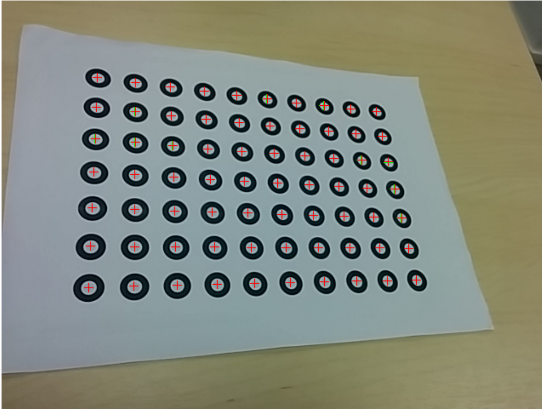
Figura 4.10: Comparação entre pontos reprojetoado e distorcidos advindos da visão frontal-paralela e pontos de controle do passo anterior.
