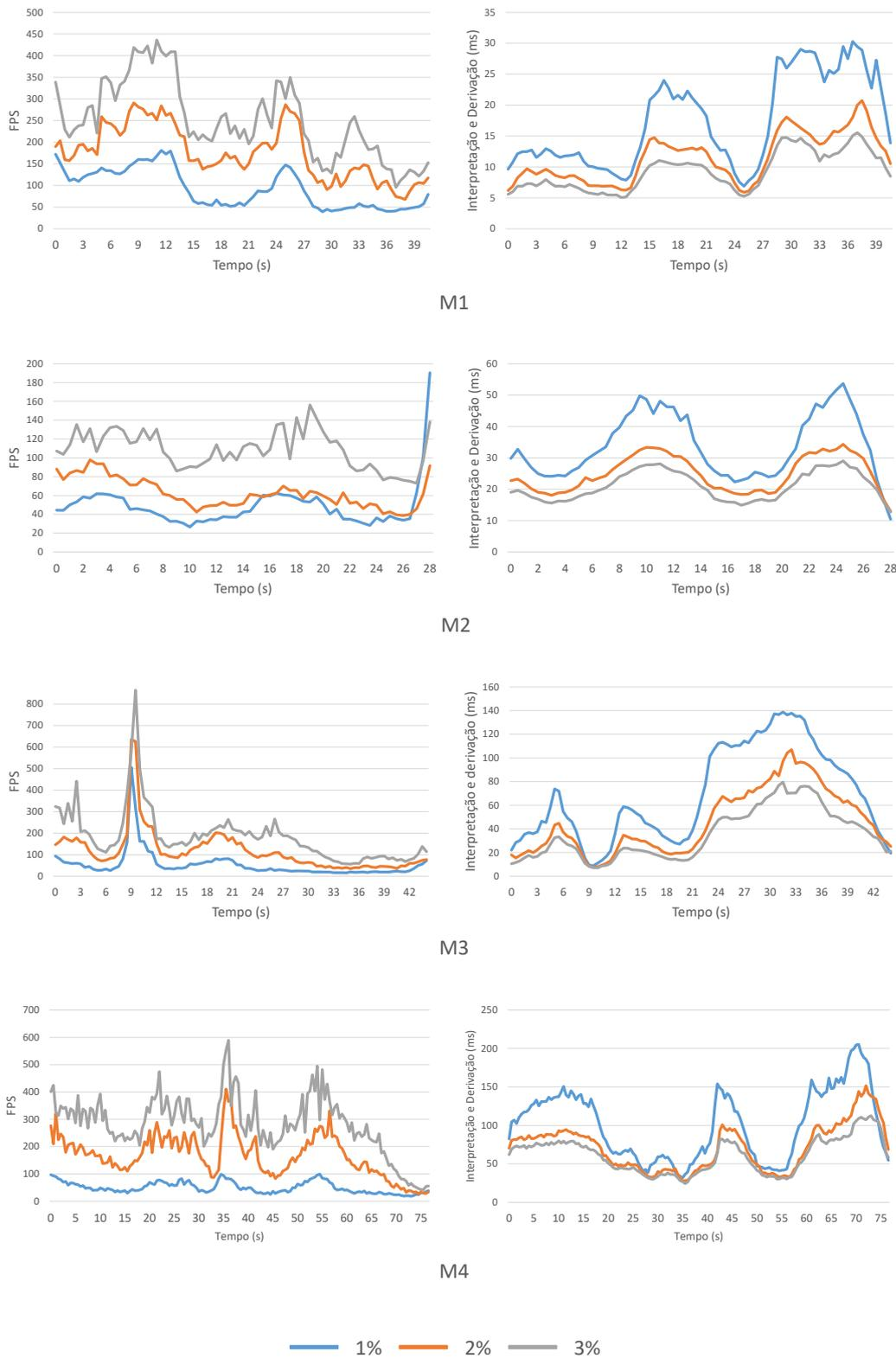
Figura 6.10: No lado esquerdo, gráficos dos FPS's ao longo do tempo para os quatro modelos na renderização assíncrona. No lado direito, tempo de interpretação e derivação em milissegundos.
