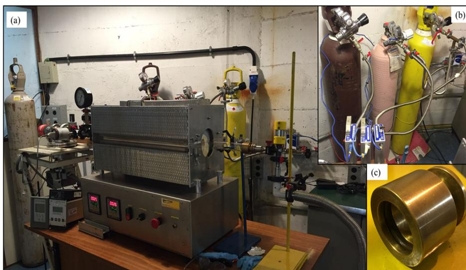
Figura 4.1: (a) O sistema CVD empregado para a preparação das amostras de grafeno sobre Ge. (b) O sistema de gases e seus controladores. (c) Peça de latão com vedação dinâmica.
