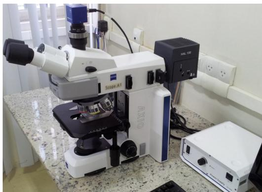
Figura 4.2: Microscópio Óptico modelo Zeiss Axio Scope.A1 usado para observar as amostras obtidas
