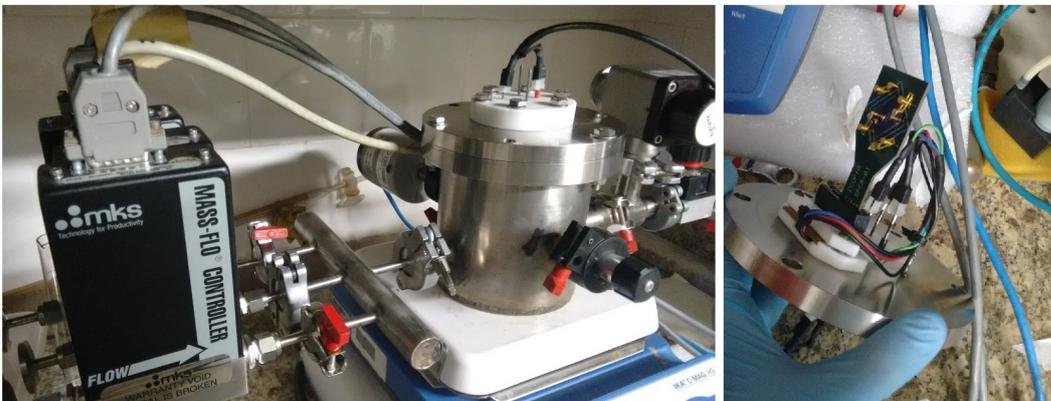
Figura 5.2: Foto do sistema de sensoriamento de gases(esquerda) e disposição do porta amostras no interior da câmara para a medição(direita)
