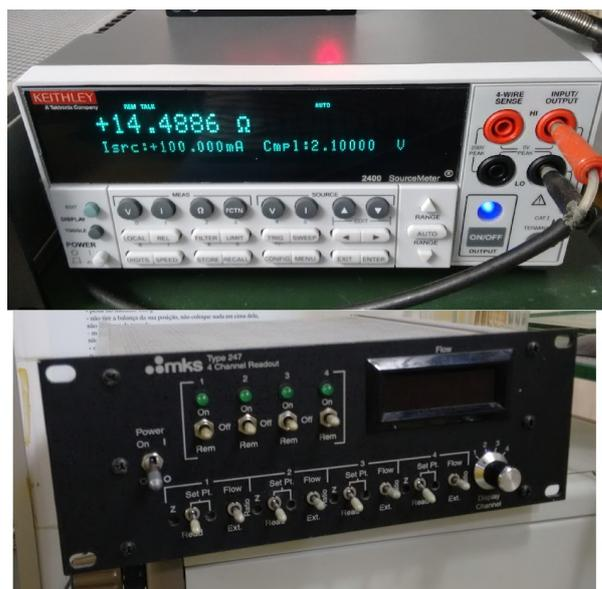
Figura 5.4: Foto da instrumentação utilizada nos experimentos: (superior) Modelo Keithley SMU 2400 com fonte de corrente e multímetro digital integrado, (inferior) unidade de controle analógica de fluxo modelo MKS 247d.
