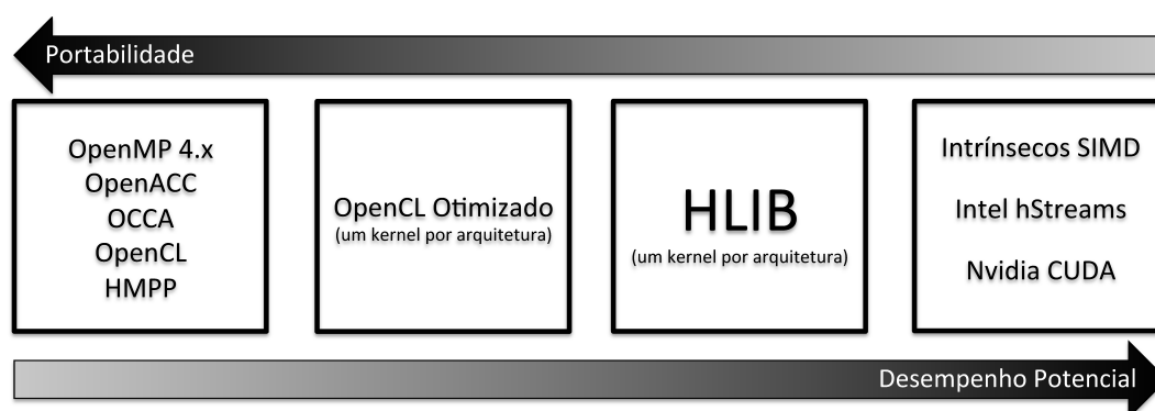
Figura 3.3: Comparativo entre o grau de portabilidade e desempenho potencial. OpenCL otimizado se refere a múltiplos kernels OpenCL otimizados para cada arquitetura. O desempenho é potencial, fica a cargo do desenvolvedor.
