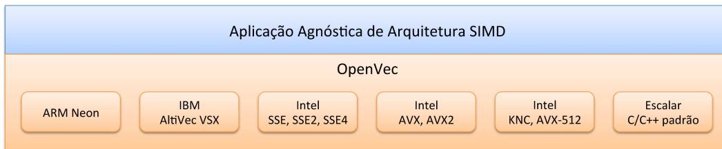
Figura 2.4: Aplicação livre de chamadas proprietárias utilizando o OpenVec, com seus diversos backends .
