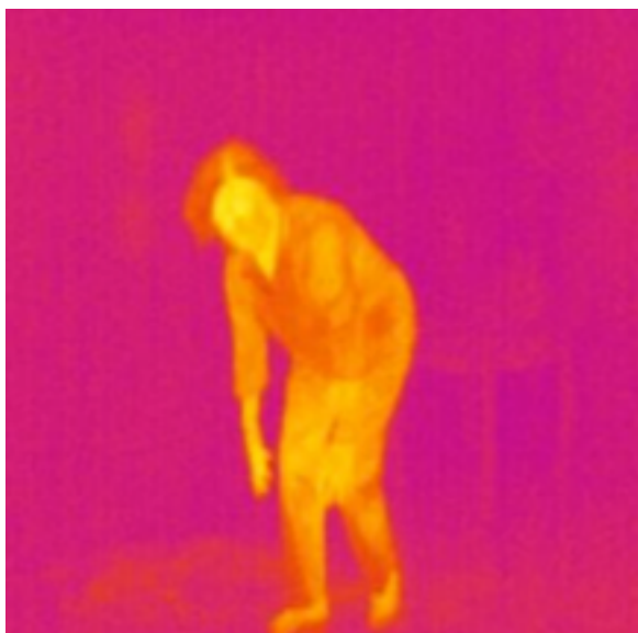
Figura 6 - Exemplo de imagem gerada por câmera térmica de resolução 320 x 240 pixels.
