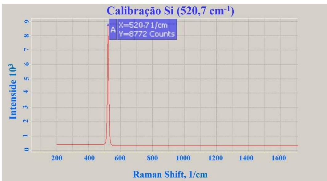
Figura 5.12 - Espectro Raman da amostra padrão de Si puro utilizada para calibrar o equipamento.
