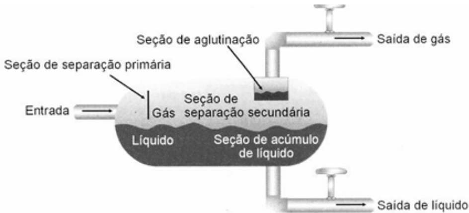
Figura 2.3: Esquema representativo de um separador bifásico horizontal. (10)
