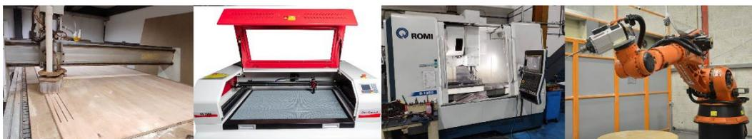
Figura 58 - CNC Router, cortadora laser, centro de usinagem, braço robótico.
