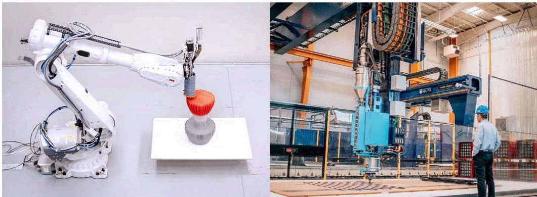
Figura 57 - Impressora 3D robótica e impressora 3D de tamanho industrial
