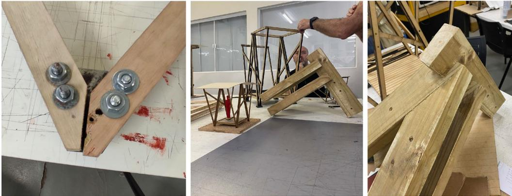
Figura 75 - WCB, evolução de solução estrutural de encaixes em madeira.
