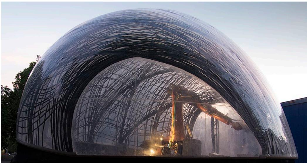
Figura 43 - Pavilhão ICD/ITKE, braço robótico aplicando filamento de carbono
