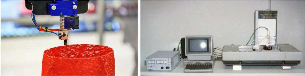
Figura 55 - Impressão 3D FDM e SLA
