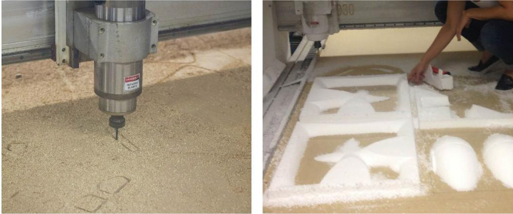
Figura 69 - Usinagem em compensado e em isopor
