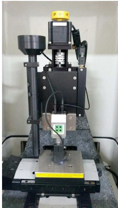
Figura 3.5 – Nanoindentador Hysitron triboindenter.
