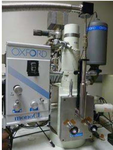
Figura 3.16 – Microscópio eletrônico de varredura equipado com o espectrômetro Gatan Mono CL2.
