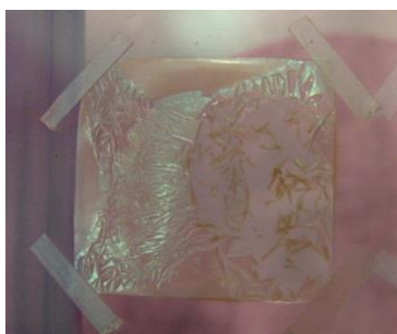
Figura 6.3: Membrana de CB recoberta com ITO após contato com água. É possível observar o filme de ITO trincado e não aderido ao substrato após a deposição de apenas uma gota de água.
