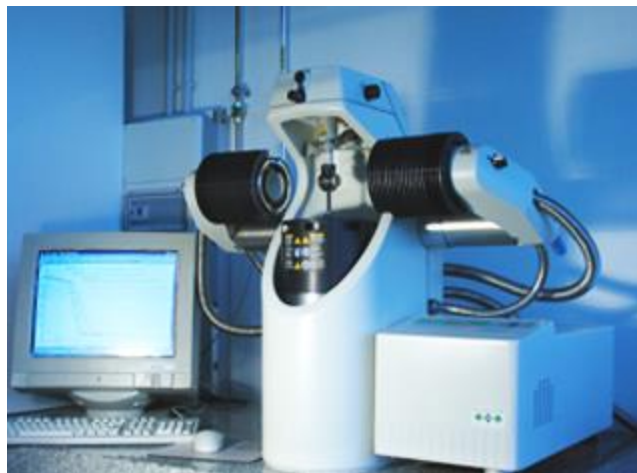
Figura 3.7: Equipamento da Mettler Toledo modelo DMA/SDTA 861e utilizado para realizar os ensaios mecânicos desta tese.
