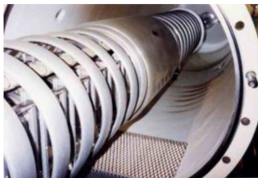
Figura 3.7: Vista do interior de um acelerador do tipo Tandem. No centro da figura está o terminal de alta tensão.
