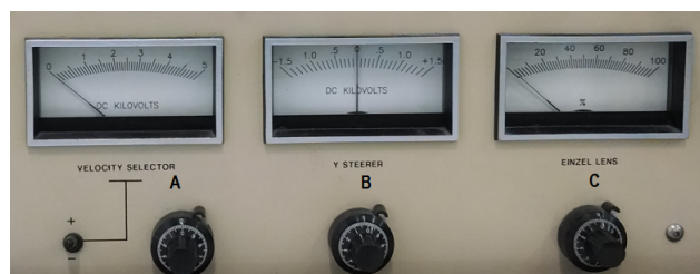
Figura 3.5: Imagem da parte do painel de controle do acelerador. (A) seletor da velocidade, (B) elemento de alinhamento do feixe Y-Steerer , (C) elemento de focalização da lente Einzel.
