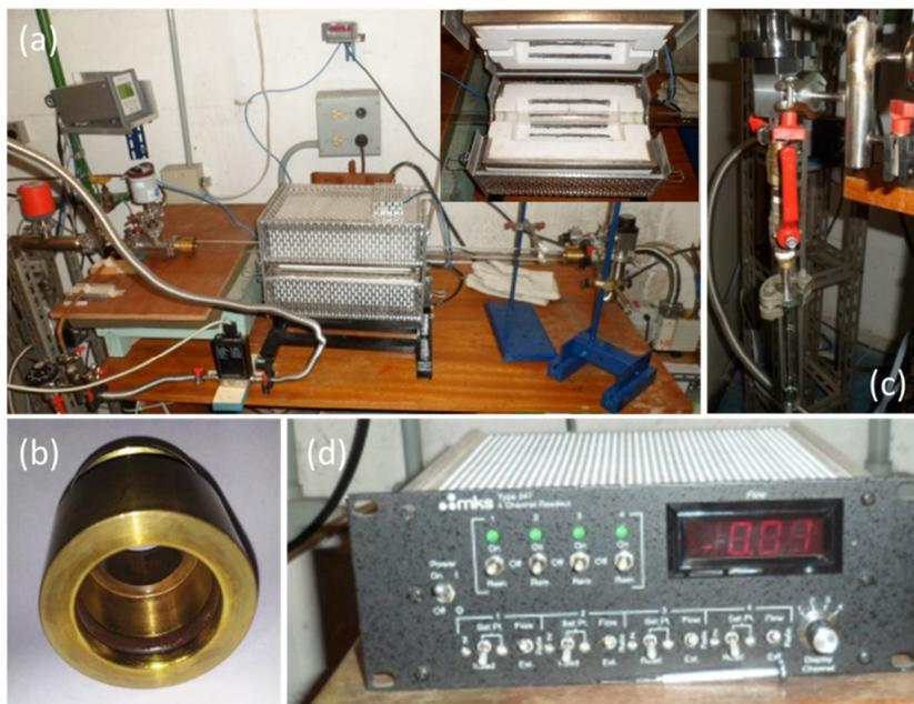
**Figura 22.** Fotografia do sistema de crescimento LPCVD (a), conector do tubo de quartzo (b), controlador de fluxo de massa (d) e o arranjo para fontes líquidas (c).
