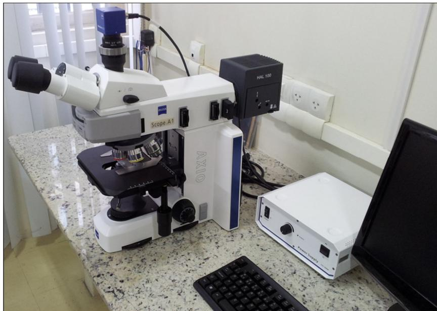
**Figura 19.** Microscópio Óptico da Zeiss integrado com o programa da Axion Vision utilizado para observar as amostras crescidas no cobre e transferidas para outros substratos.
