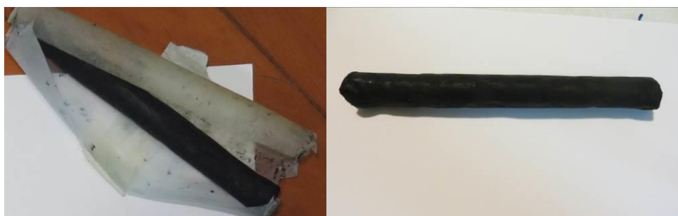
Figura 35. Giz pastel oleoso após secagem. Aspecto firme, com leve brilho proveniente da cera e do óleo de linhaça que fazem parte de sua composição. As barras foram acondicionadas enroladas em papel manteiga.
