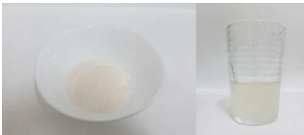
Figura 25. Metil celulose utilizada como aglutinante para a confecção do giz pastel. À esquerda, o produto em pó, como é comercializado, à direita já misturado com água após molho de 3 horas.
