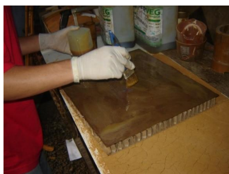
Figs. 47 e 48: Sanduíche de fibrobarro e resina de mamona, com recheio de honey-comb .
