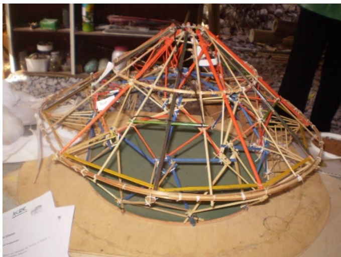
Fig. 11: Miniatura da capela de Andrelândia. Esse foi um projeto do LILD em parceria com um sítio em Andrelândia, MG, para a construção de uma capela de bambu e fibras naturais. A capela foi construída junto com as pessoas do local.
