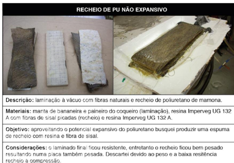
Fig. 49: Um dos experimentos de 'sanduíche' laminado feito por João Rivera Monteiro
