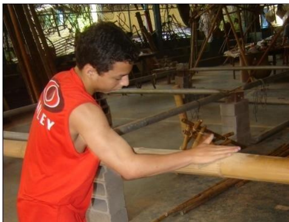
Fig. 35: Lixamento do bambu, primeira parte do tratamento
