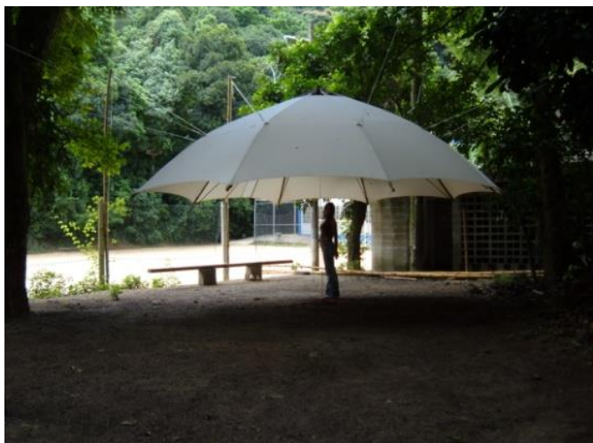
Fig. 21: Cobertura leve tensionada baseada nas sombrinhas chinesas
