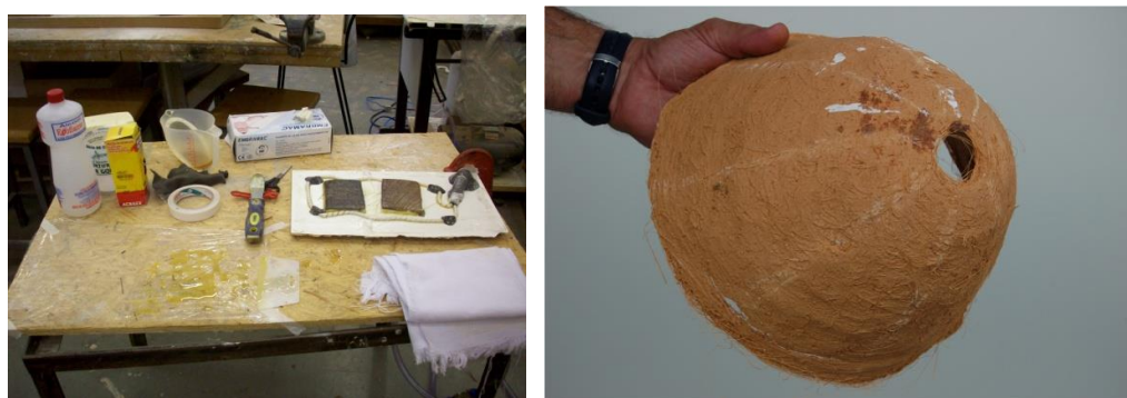
Fig. 26 e 27: Alguns materiais pesquisados no LILD – compósito de resina de mamona e fibras e compósito de barro e fibras.
