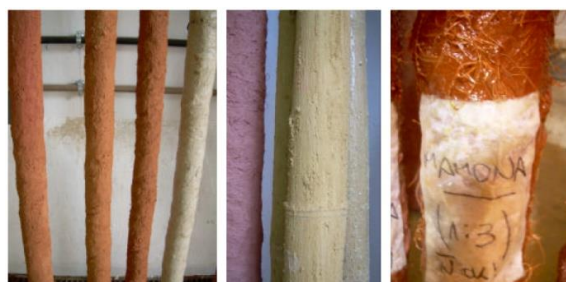
Figs. 36 e 37: Acima, bambu encapsulado com gase, areia e resina de mamona, tratamento que apresentou boa resistência e, abaixo, experimentos de bambu encapsulado com terra, resina ou fibras.
