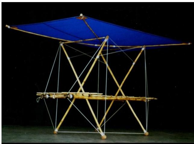
Fig.20: Barraca de feira desenvolvida no LILD: exemplo de estrutura autotensionada e autoportante.
