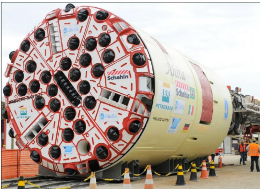
Figura 2-24. TBM Anita, primeira TBM de shield duplo para rocha utilizada no Brasil (Rocha, 2012).
