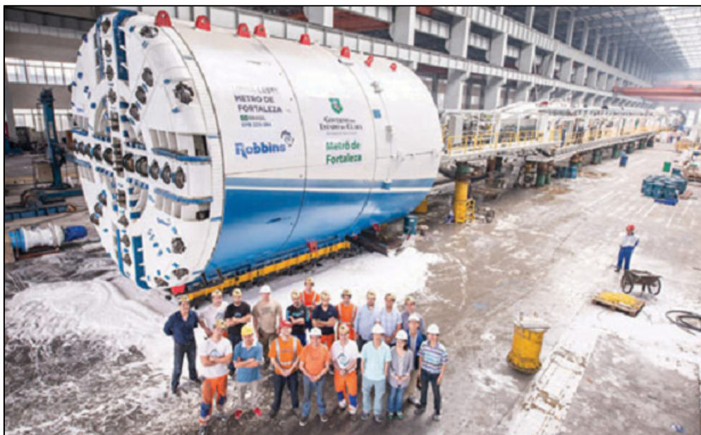
Figura 2-25. TBM Robbins para Linha 3 leste do metrô de Fortaleza, Ceará (Palma et al. , 2014).
