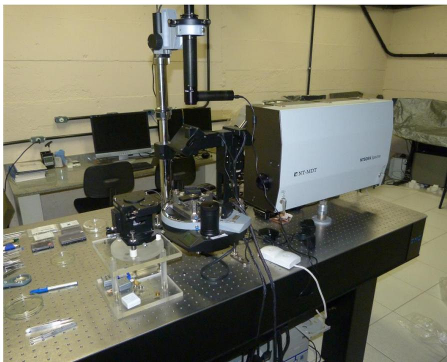
**Figura 2.8:** Fotografia do espectrômetro Raman instalado no laboratório de Revestimento Protetores e Materiais Nanoestruturado.
