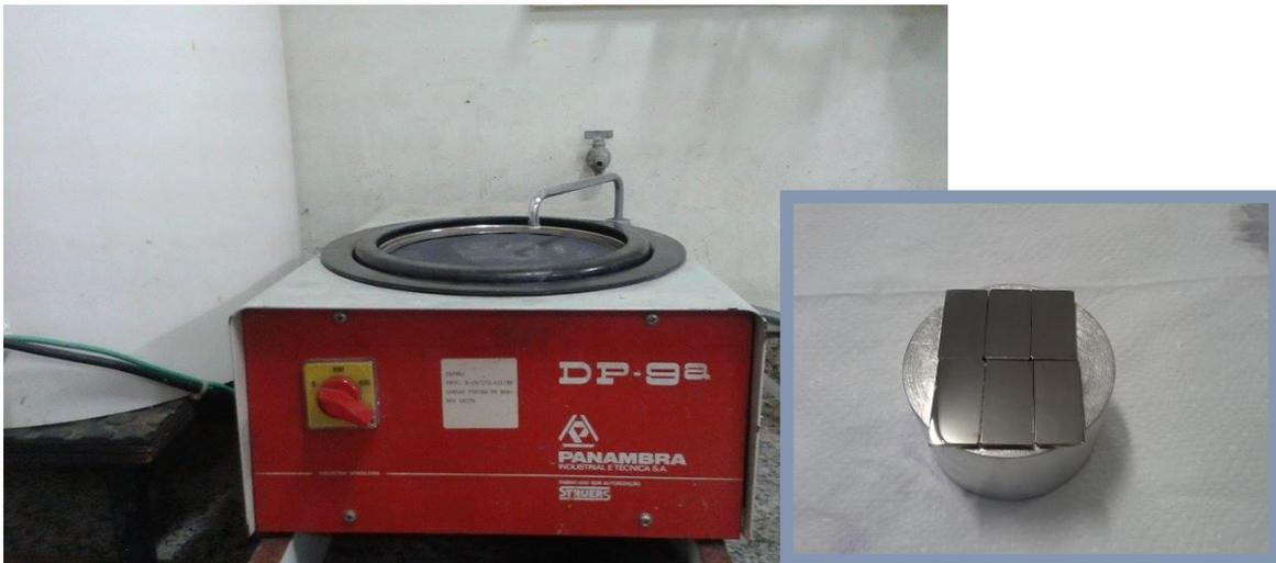
**Figura 2.4:** Equipamento para polir os substratos de aço e a imagem inserta mostra como foram colados os substratos de aço no cilindro.
