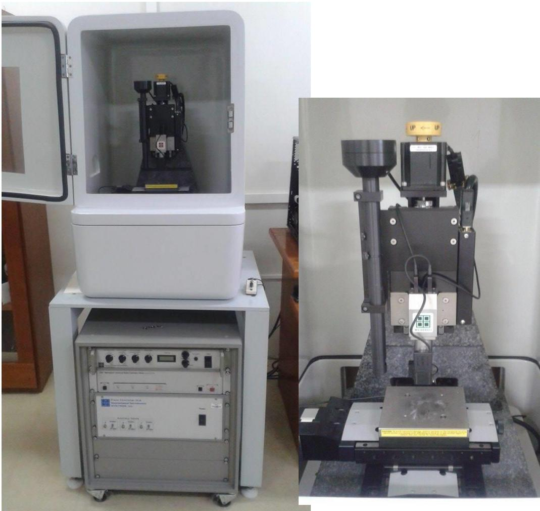
**Figura 2.16:** Fotografia do equipamento com o qual se fizeram as medições de nanoindentação.
