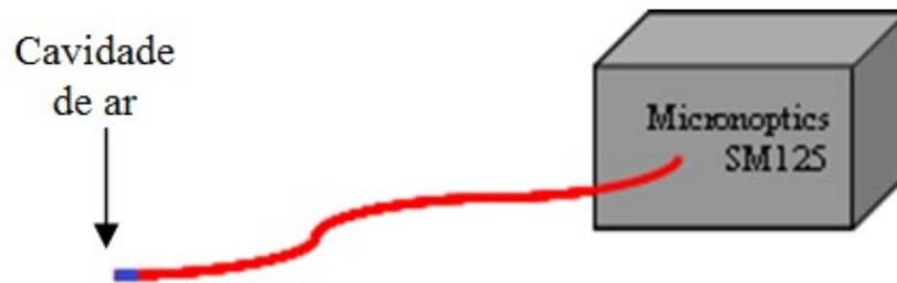
**Figura 12– Desenho esquemático da montagem experimental para a caracterização do sinal de uma fibra óptica com cavidade Fabry-Perot.**
