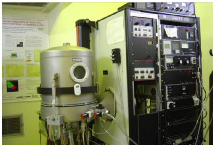
Figura 3.4 Equipamento utilizado no LOEM para a deposição por Electron beam.
