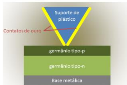
Figura 1.1 Diagrama do dispositivo de ponto de contato. Figura retirada da referência (Maciel, 2012).
