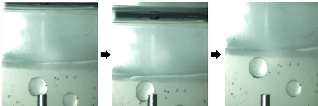
**Figura 48 – Dispersão aquosa de Laponita® RD 1,0% + 0,008 M de NaCl (dia 0) no sistema óleo-água.**
