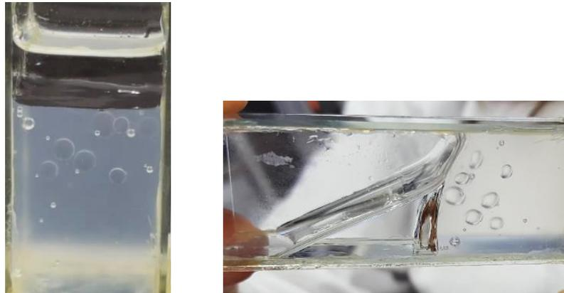
**Figura 47 – Dispersão aquosa de Laponita® RD 1,0% + 0,01 M de NaCl (dia 7) no sistema óleo-água.**
