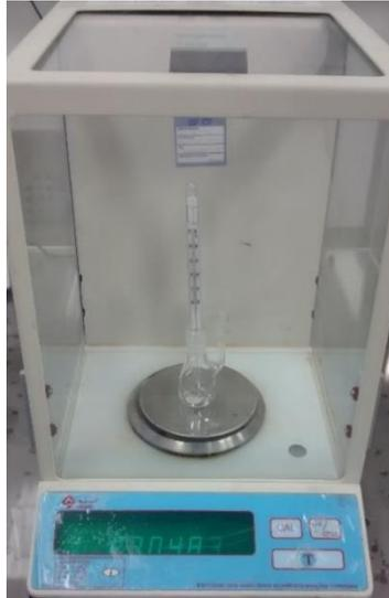
Figura 27 – Balança analítica mais picnômetro.
