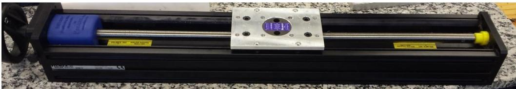
Figura 25 – Carro que deslocava horizontalmente o Elevador 2 (Figura 24a).
