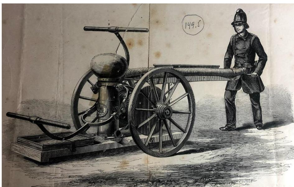
Figura 18. Modelo de uma das bombas manuais adquiridas pelo Corpo de Bombeiros do Rio de Janeiro em 1862 conforme panfleto da empresa *Roberts's Portable Fire-Engine*, 1880, p. 33, anexo ao AN, *Série Justiça*, IJ8-3, nº 149, “Ofício do diretor-geral do Corpo de Bombeiros, Juvencio Manoel Cabral de Menezes, ao ministro da Agricultura, datado de 22 de outubro de 1861”.
