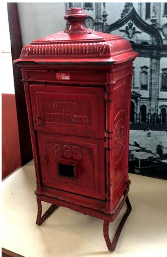
Figura 12. Modelo de Caixa avisadora instalada nas ruas do Rio de Janeiro a partir de fins de 1879, fabricada pela *Siemens & Halske*. Foto: Arquivo Pessoal (Museu Histórico do Corpo de Bombeiros Militar do Estado do Rio de Janeiro [doravante MHCBMERJ] Mar, 2019).
