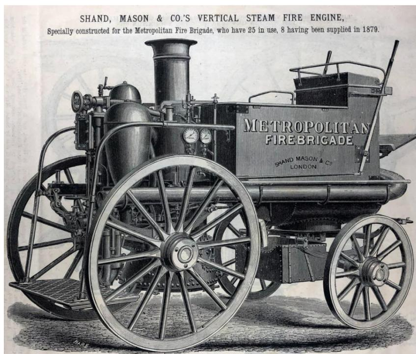
Figura 17. Modelo de bomba a vapor adquirida pelo Corpo bombeiros fabricada pela *Merryweathers Improved patent*, modelo Single cylinder 5 ½ diameter, and a Gun Metal direct, London Fire Brigade pattern Steam Fire Engine. Catálogo da empresa *Shand, Mason & Co*, 1880, p. 18, anexa ao AN, *Série Justiça*, IJ8-37, nº 179, “Ofício do diretor-geral do Corpo de Bombeiros, João Soares Neiva, ao ministro da Agricultura, datado de 11 de novembro de 1881”.
