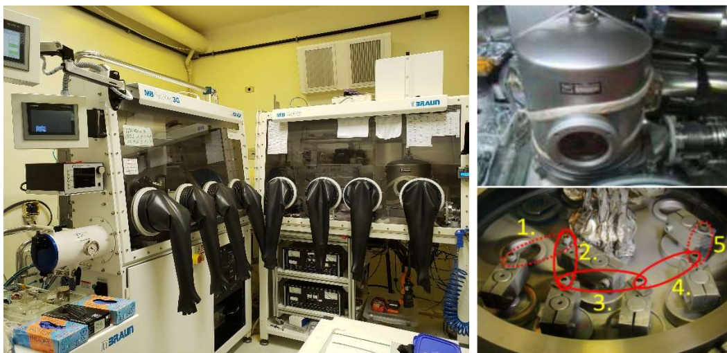
Figura 21- Fotografia dos sistema de deposição Leybold 300 acoplada a uma glovebox Mbraum (esquerda), a câmara de deposição (direita, cima), as 5 disposições possíveis para a colocação de cadinhos na câmara de deposição (direita, baixo) [75].
