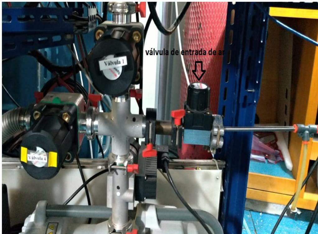
Figura E.1: Válvulas 1, 4 e de entrada de ar.
