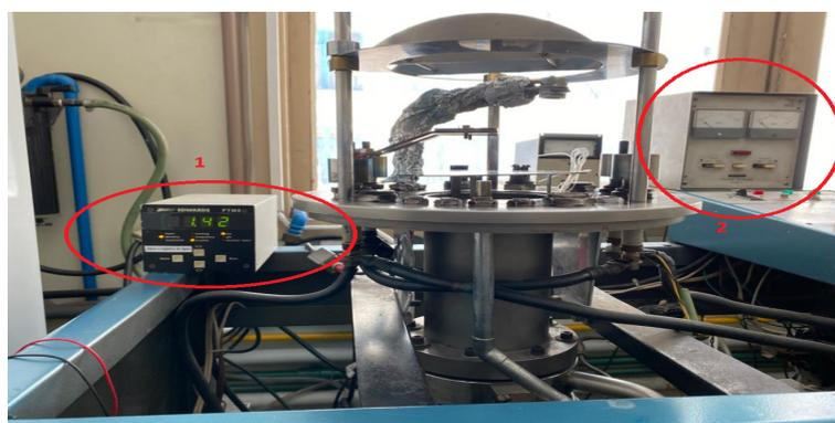
Figura 3.5: (1) controlador da medida da espessura e (2) Medidor *Penning*. suporte da balança de quartzo envolto por papel de alumínio.
