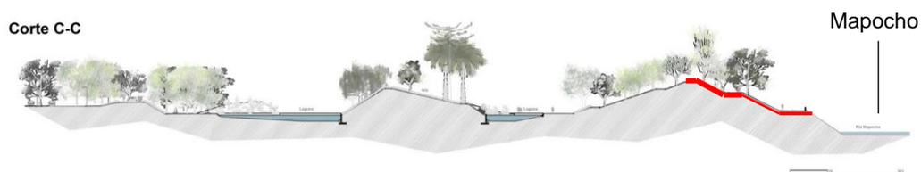
Figura 30 - Corte transversal de relação do parque criado com o rio Mapocho. A linha em vermelho destacada representa o que seria essa criação de terraços para o escoamento das águas. Fonte: Parque (2016), adaptado pela autora.
