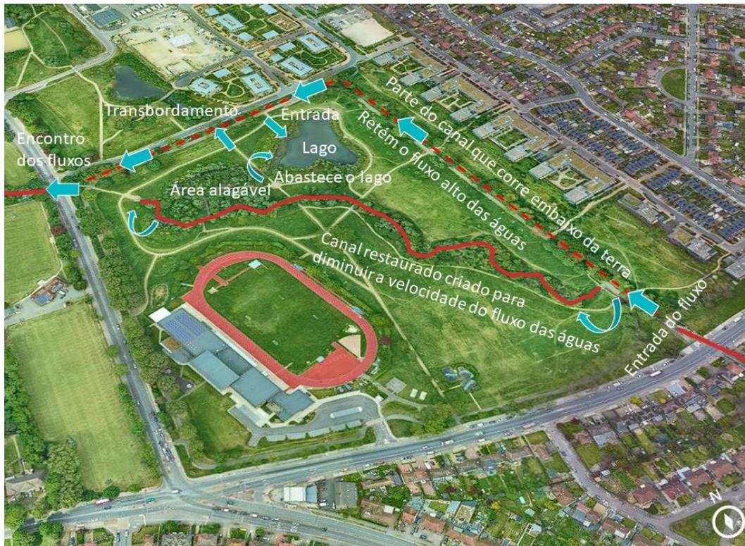
Figura 55 - Mudanças no fluxo de água para diminuir a velocidade das águas escoadas, no Sutcliffe Park. Fonte: Google Earth<sup>98</sup> e RESTORE (2017), adaptado pela autora e tradução nossa.
