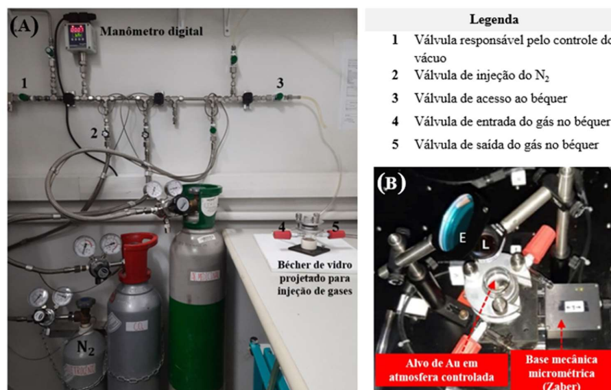
Figura 3.5: (A) Configuração experimental para o preparo da amostra em atmosfera controla. (B) Sistema de PLA em atmosfera controlada (em que E representa o espelho e L a lente).
