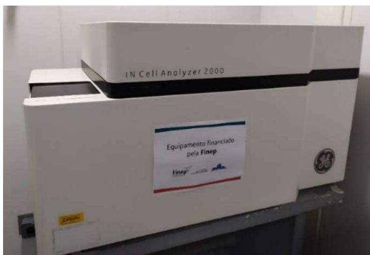
Figura A.11: Microscópio óptico de epifluorescência automatizado, InCell Analyzer 2000 , localizado no Laboratório de Biotecnologia (LABIO) do Instituto Nacional de Metrologia, Qualidade e Tecnologia (INMETRO).
