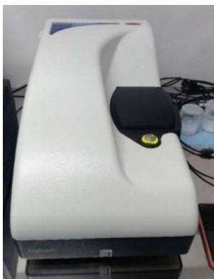
Figura A.6: Aparelho de espalhamento dinâmico de luz (DLS) ZetaSizer Nano Series – ZS localizado no Laboratório de Biotecnologia (Labio) do Instituto Nacional de Metrologia, Qualidade e Tecnologia (INMETRO).
