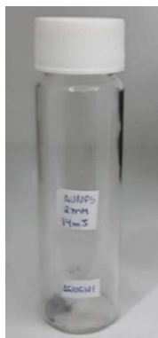
Figura 3.8: Amostra liofilizada das AuNPs, sintetizadas por PLA, com 2mM de NaOH.
