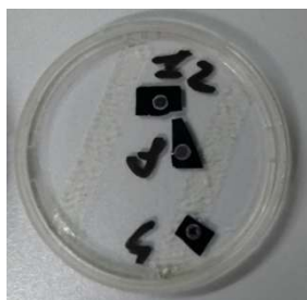
Figura 3.12: Dispersão coloidal de AuNPs depositadas (4, 8 e 12 gotas) no substrato de silício.
