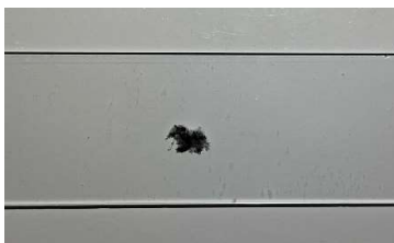
Figura 3.13: AuNPs com 2mM de NaOH feita em ar e liofilizadas depositadas no substrato de vidro.
