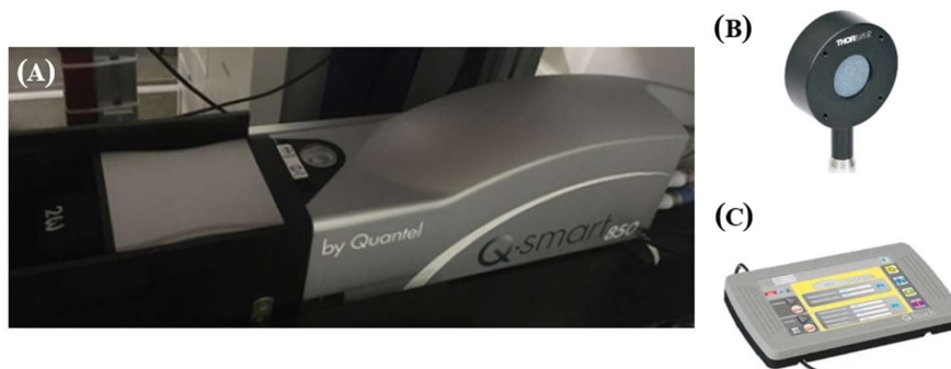
Figura 3.2: (A) Fonte de laser Nd:YAG pulsado Q-smart 850 da Quantel, operado com módulo para a frequência do segundo harmônico 2\omega . (B) Detector piroelétrico de energia. (C) Controle do laser Q-smart 850.
