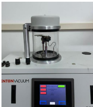
Figura 3-3 DentonVacuum Desk V – Equipamento para sputtering do filme de Au.
