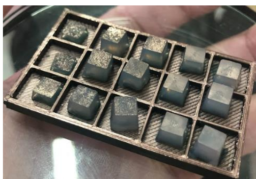
Figura 3-4 Xerogeis após a deposição de Au feita através do processo de sputtering .
