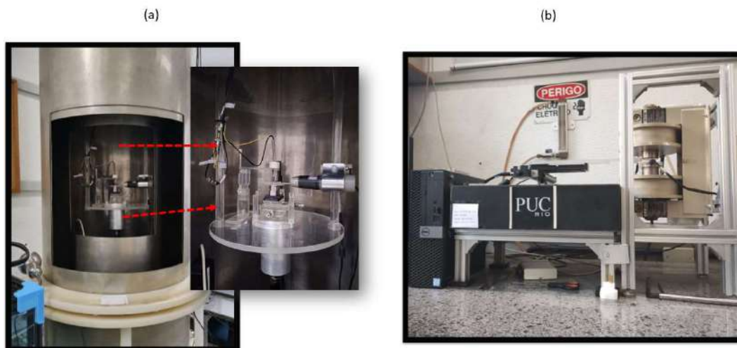
Figura 3-1 Os microscópios magnéticos de varredura foram construídos no LIMM da PUC-Rio. (a) com blindagem (b) sem blindagem.
